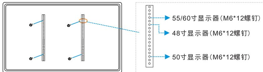
2. 用 4 颗螺钉将双屏支架固定在一体化支架的两个固定夹上；
