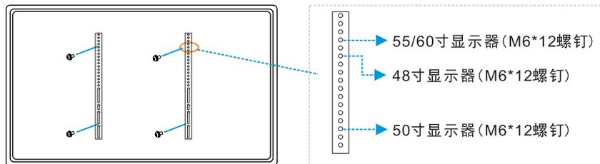
2. 用 4 颗螺钉将单屏支架固定在一体化支架上，将显示器挂在单屏支架上；
