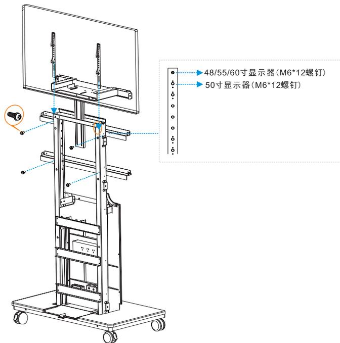
3. 将电视固定支架插入单屏支架内，先用 1 颗 M4\*8 的螺钉将电视固定支架侧面锁住，再用 1 颗 M4\*8 的螺钉锁定电视固定支架；
