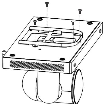
将钣金支架 A 以 4 颗十字槽 M3×5 螺钉锁固于机器底座
