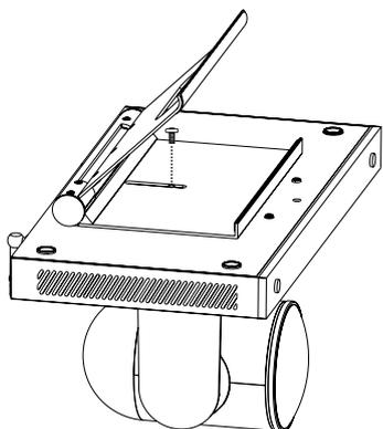
将支架打开一定的角度，并用 1 颗十字槽英制 1/4-20×7 螺钉将支架锁固于终端
