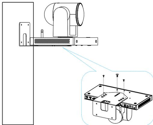
将终端以 2 颗十字槽 M3×5 螺钉以及 1 颗十字槽英制 1/4-20×7 螺钉锁固于钣金支架上
