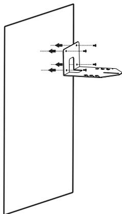
在墙壁上打出 4 个 6mm 的孔，将钣金支架以 4 颗 ST5×35 螺钉以及 PE 塑料柱子锁固于墙壁上
