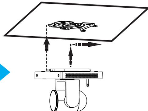
将钣金支架 A 上推至天花板向右卡入钣金支架 B，再锁上 1 颗十字槽 M3×5 螺钉固定
