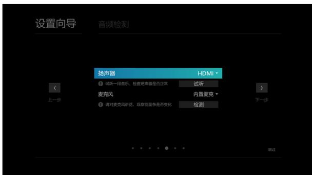
5. 音频检测：检测音频输入接口信号状态以及输出声音试听
